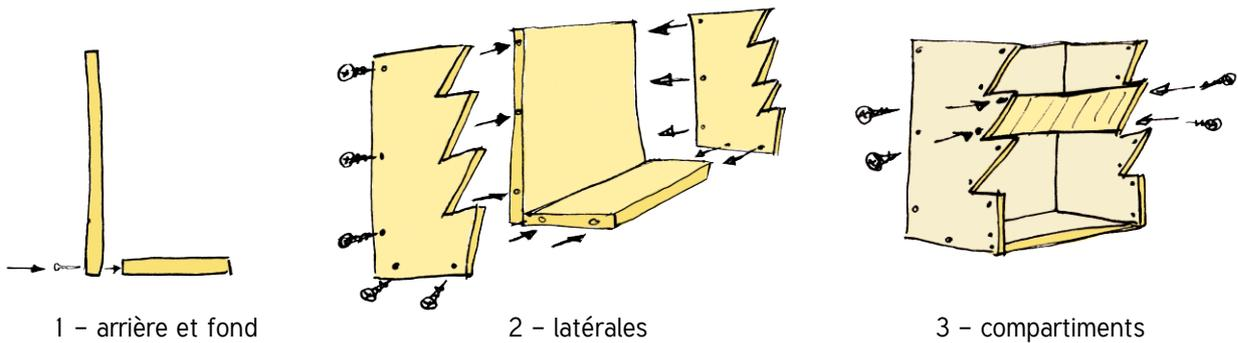
**2.** Assembler avec la visseuse et les vis après avoir fait des pré trous. Commencer en assemblant l'arrière et le fond, puis les latérales, et ensuite les 4 compartiments.
