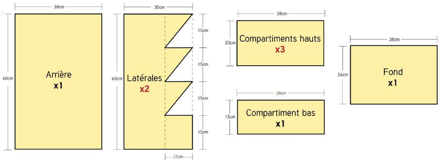
**1.** Découper les planches de bois de 2cm d'épaisseur selon les plans et les quantités indiqués ci-dessus. Pour cela, il faut d'abord tracer les cotes indiquées avec la règle et l'équerre, puis découper soigneusement à la scie sauteuse en vous installant sur un établi ou une table.
